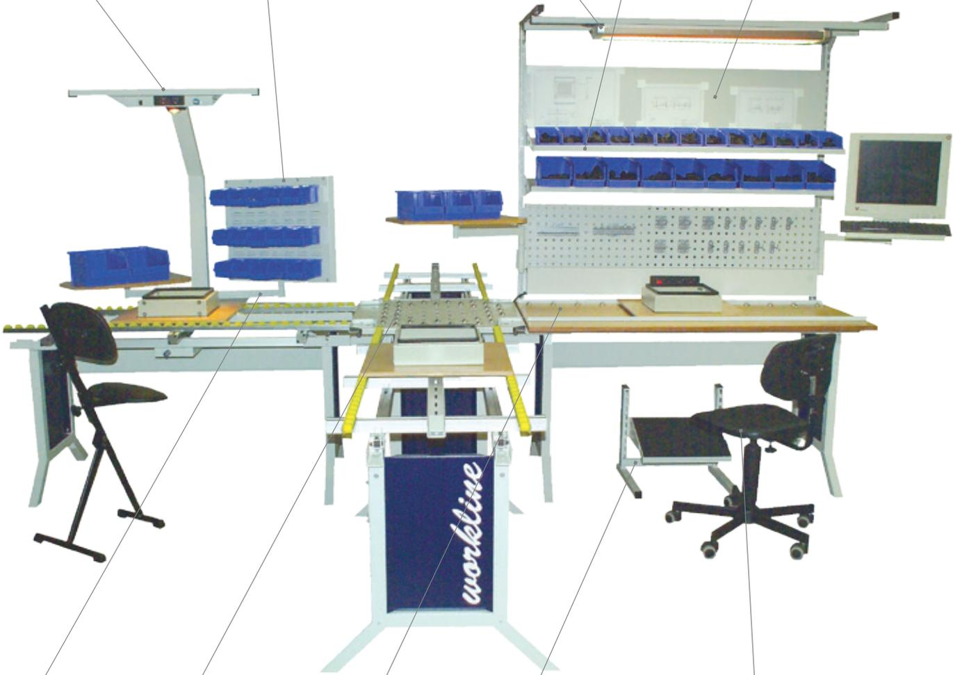
Schwenkarm    Kugeltisch-Brücke    Arbeitskugeltisch    Fußstütze    Stühle/Stehhilfen
