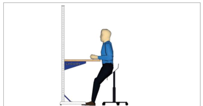
**Knotenbleche** Die Obergestelle E / D sowie Holzfachböden werden individuell nach Körpergröße mittels Knotenblechen an der Tragsäule befestigt.
