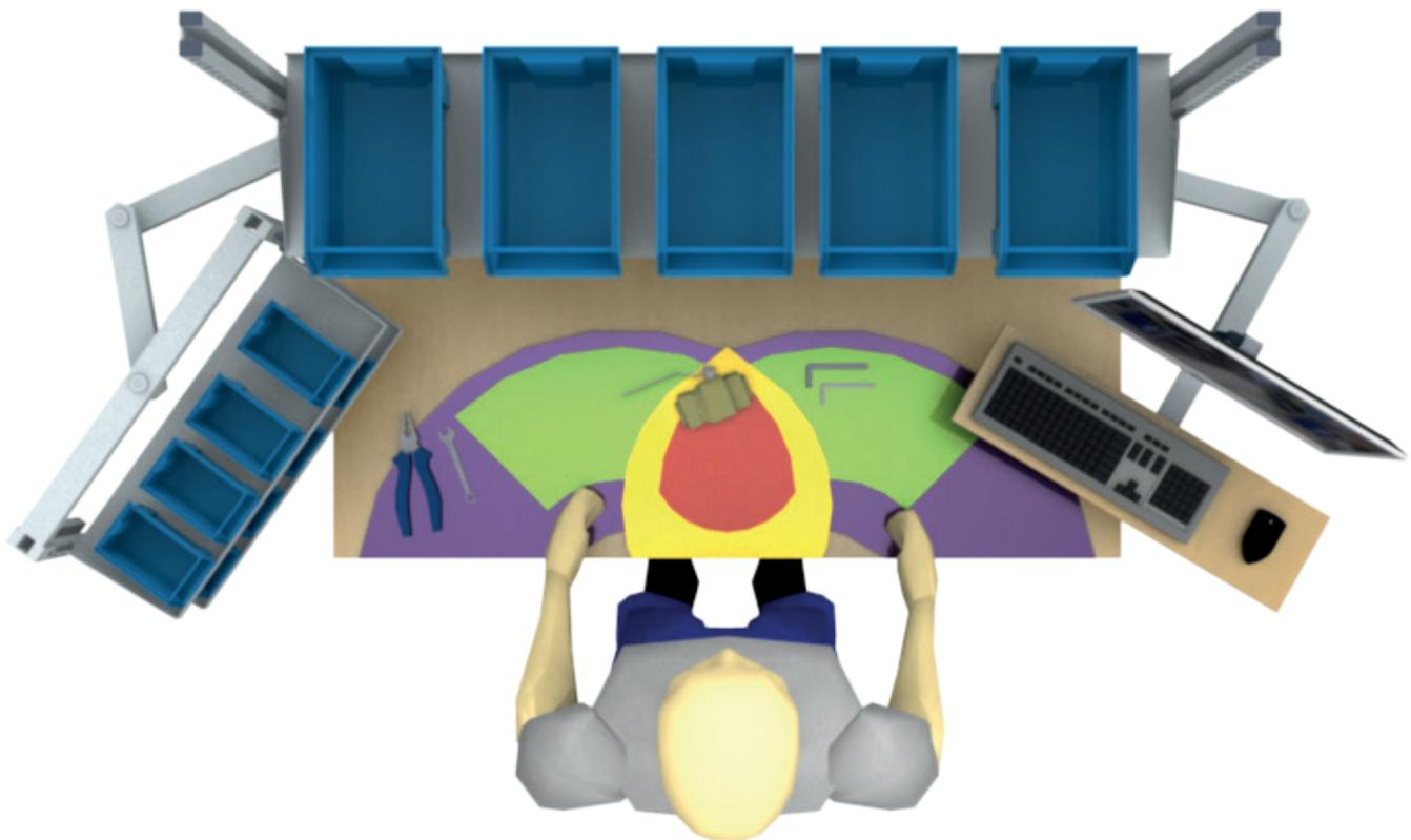
Die Schwenkarme lassen sich über drei Achsen innerhalb der Greifräume gemäß aktueller Arbeitsfolge frei bewegen. Sie ermöglichen kurze Aufnahmestrecken bei uneingeschränkter Montagezone.
