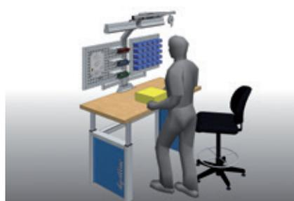
Stehend arbeiten, kleines Werkstück und große Arbeitshöhe
